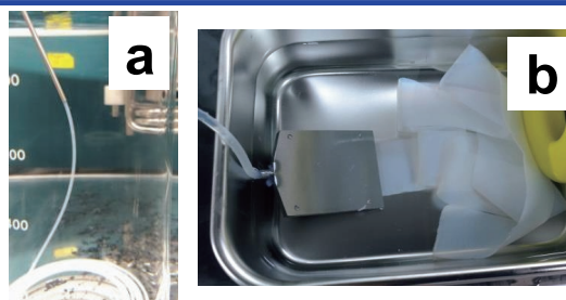
図1 コラーゲン線維ゲルの連続吐出の様子 (a) 内径2 mmのステンレス管からの紐状コラーゲンゲル、(b) 断面が1 mm×35 mmのスリットからの帯状コラーゲンゲル
