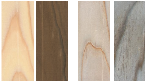
無処理木材 熱処理木材 無処理木材 熱処理木材 促進耐候試験前 促進耐候試験500時間後
