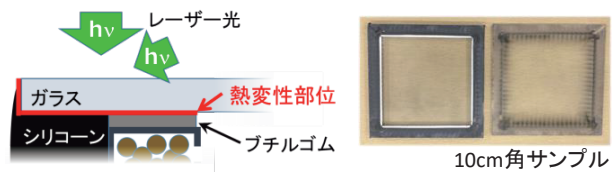
図2 レーザーによる剥離
